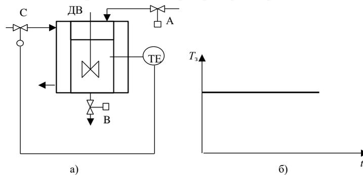
Открыть клапан А на 30 секунд. Затем включить мешалку и поддерживать температуру по заданной программе в течении 1 часа (б). Далее открыть клапан В.
