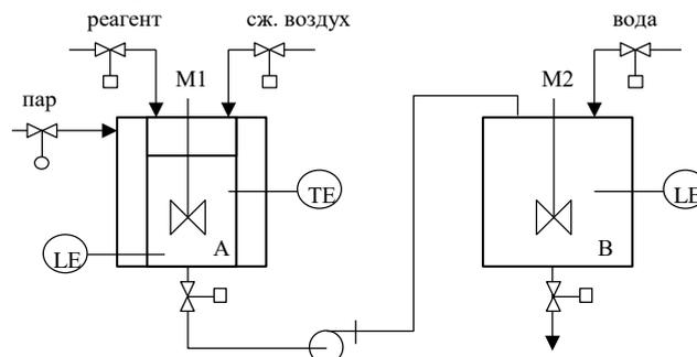
6. Разработать приложение на языке SFC реализующее следующий алгоритм управления. В емкость загрузить вещество А до уровня 1.5 м. Включить мешалку. Нагреть вещество до 70 °С. Затем загрузить вещество В до уровня 2.6 м. Выдержать смесь в аппарате в течении 1 часа при температуре 70 °С. Выключить мешалку и слить полученную смесь С.
