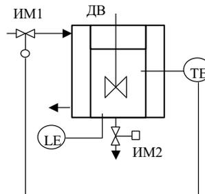
5. Разработать приложение на языке SFC реализующее следующий алгоритм управления. Предварительно аппарат А просушить в течении 10 минут сжатым воздухом. Затем закачать реагент, включить мешалку, нагреть до температуры 80 °С, выключить мешалку, перекачать в аппарат В. Одновременно с просушкой аппарата А в аппарат В закачать воду и включить мешалку. Перед закачкой реагента в аппарат В из него слить воду.
