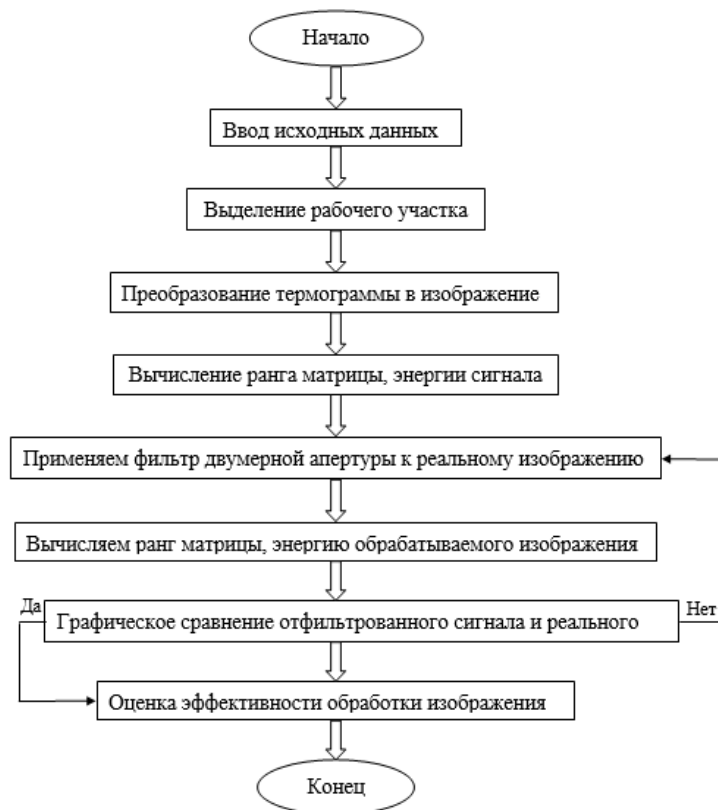
Рис. 1. Блок-схема алгоритма метода
