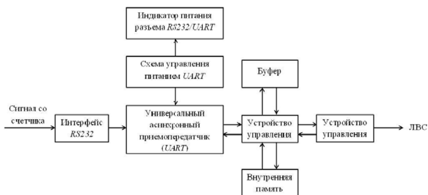
Рис. 2. Структурная схема УПИ
