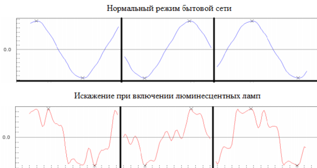
Рис. 2. Влияние работы люминесцентных ламп на качество тока и напряжения электрической сети
