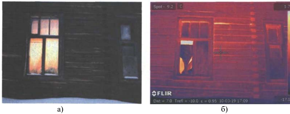
Рисунок 1 – Потери тепла в местах конопатки паклей горизонтальных соединений брусьев в стенах
