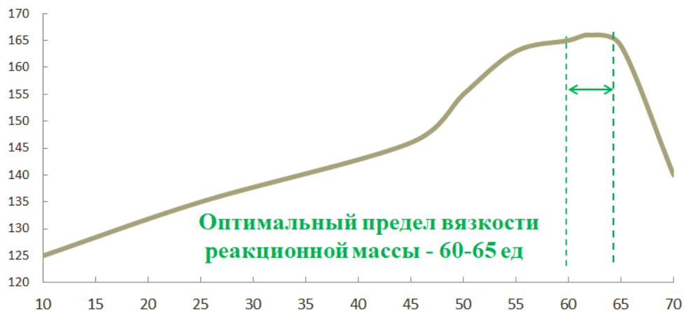
Рисунок 9 – Зависимость растекания цементного теста от вязкости пластифицирующей добавки.
