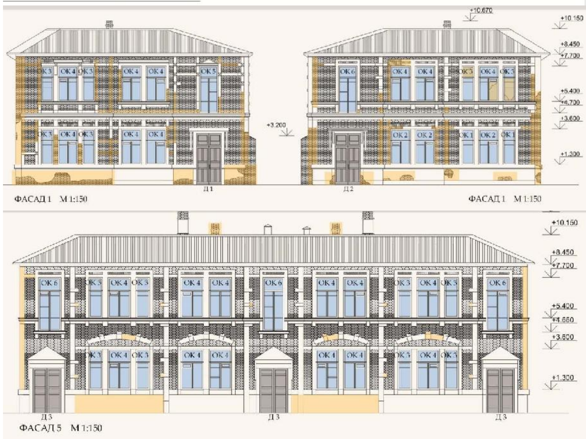
Рисунок 2 – Анализ современного состояния фасадов и архитектурных деталей исторически ценного архитектурного объекта «Бывшие доходные дома М.В. Асеева»
