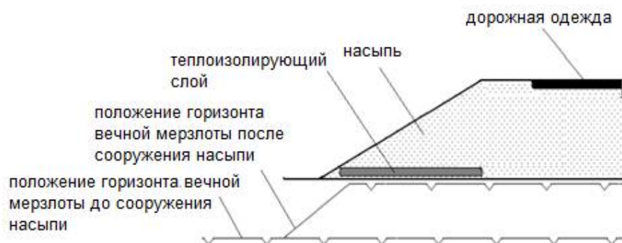
Рисунок 2 – Принципиальная схема дорожной конструкции в зоне вечной мерзлоты
