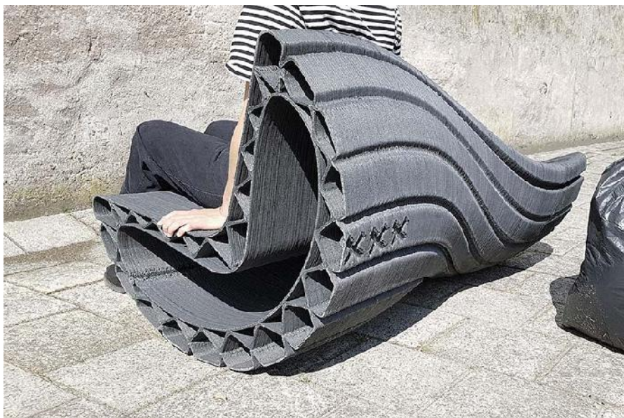
Рисунок 2 – Скамейка, напечатанная на 3D-принтере из пластиковых отходов. Дизайн-студия «The New Raw» из Амстердама
