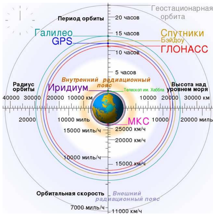
Рисунок 1 -Сравнение орбит разных ГНСС
