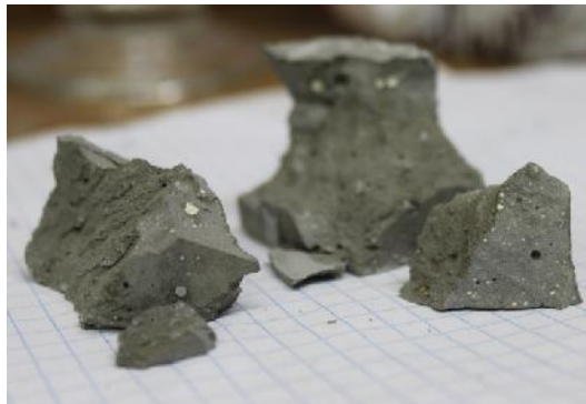
Рисунок 3 - Растрескивание бетонного образца, вследствие избыточного содержания фтористых солей-добавок
