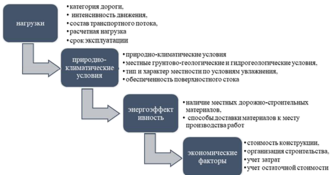
Рисунок 1 – Блок-схема выбора оптимального варианта конструкции дорожной одежды
