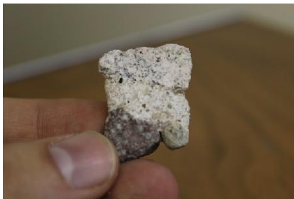
Рисунок 1- Потеря массы бетонного образца, испытанного в 40%-ом растворе HF сроком 7 суток, вследствие процесса фторидной коррозии
