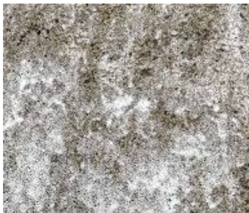
Рисунок 2 - Образование высолов фторида кальция на поверхности бетона после вымачивания образца в 20%-ом растворе NaF сроком 21 сутки
