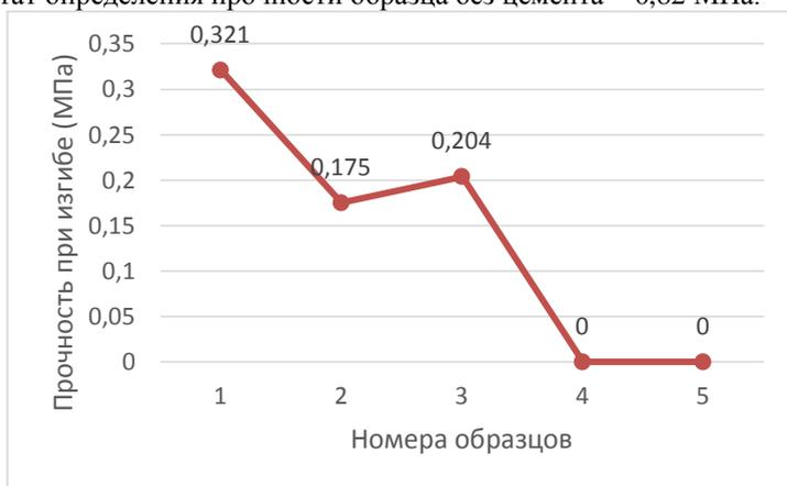
Рисунок 2 - Изменение прочности при изгибе образцов материалов в зависимости от соотношения массовой доли отходов в вяжущем
