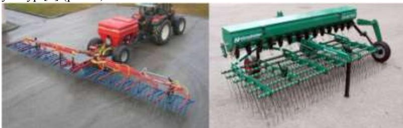
Рисунок 6 - Борональные агрегаты с оборудованием для подсева и внесения удобрений
