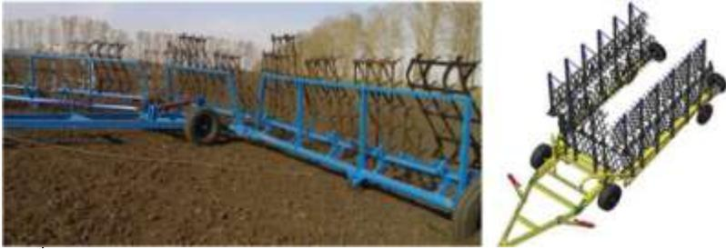
Рисунок 2 - Зубовые бороны на гидрофицированной сцепке
