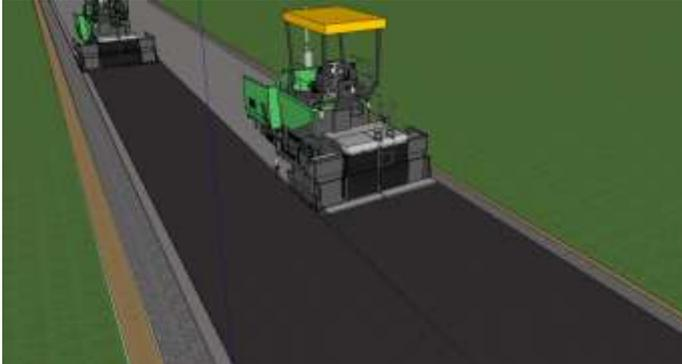
Рисунок 1 - Укладка дорожного покрытия двумя асфальтоукладчиками
