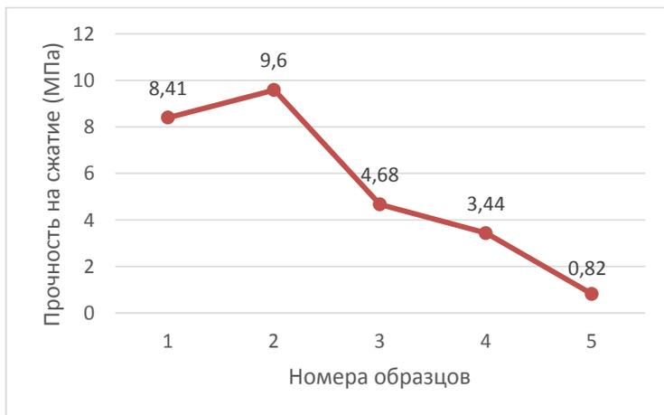
Рисунок 1 - Изменение прочности на сжатие образцов материалов в зависимости от соотношения массовой доли отходов и вяжущего
