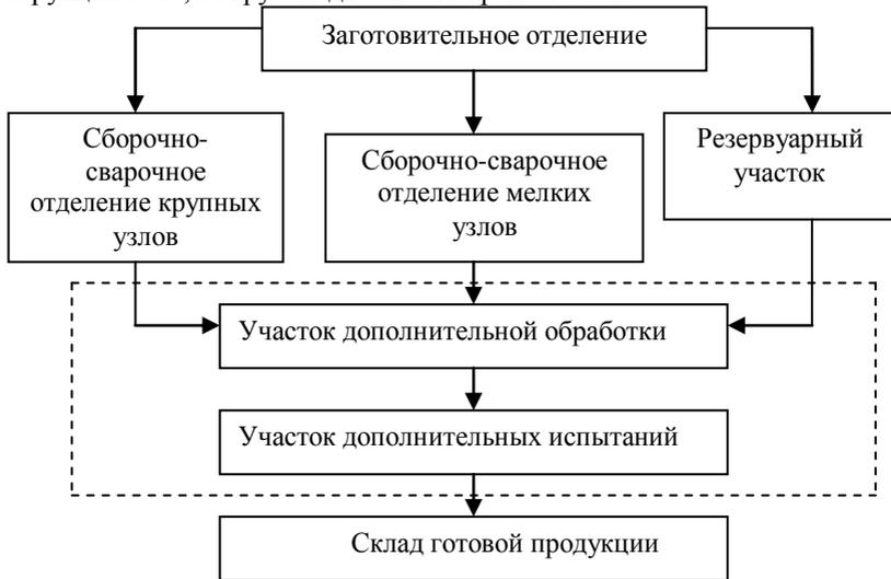
Рисунок 1 - Технологическая схема цеха металлических конструкций
