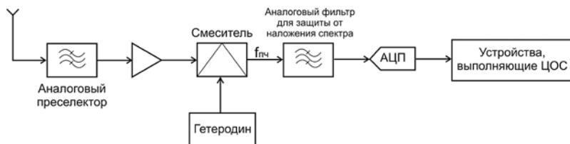
Рис. 2. Структура приемника с ЦОС по промежуточной частоте
