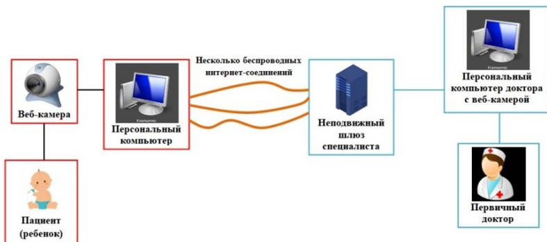
**Рис. 1. Амбулаторная система неонатальной телемедицины**
