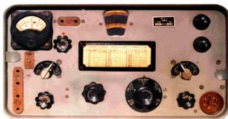
**Рис. 4. Разведприемник «Выраж»**
