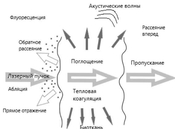
**Рис. 1.** Схема взаимодействия оптического излучения с кожным покровом
