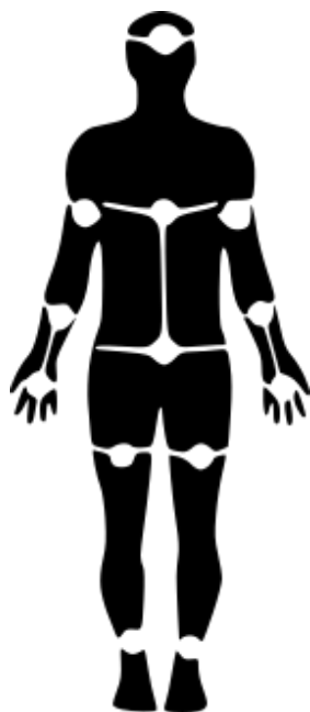
Рис. 1. Расположение IMU датчиков во время эксперимента
