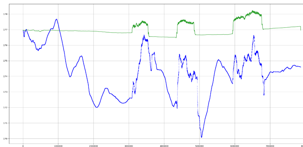
Рис. 7. Высота с Unicore во время движения: синий – сырая высота; зеленый – проинтегрированная h компонента скорости (со скользящим средним)
