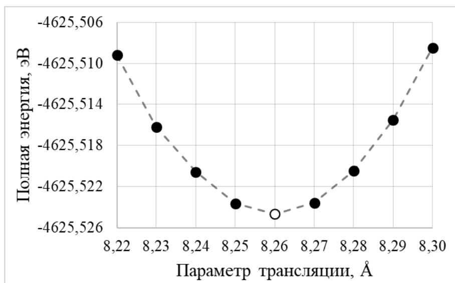
Рис.2. Зависимость полной энергии монослоя C_2O от параметра трансляции ячейки моделирования; выбранное оптимальным значение трансляции соответствует минимуму полной энергии и обозначено выколотой точкой.
