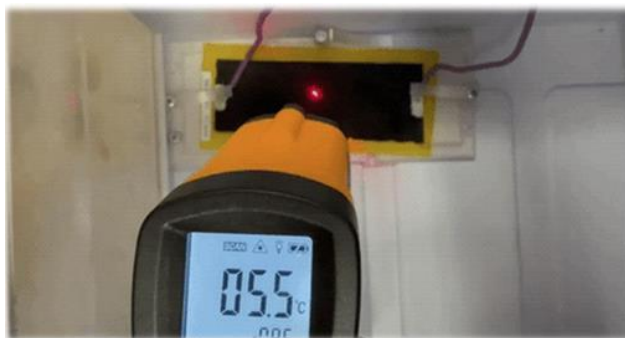
Рис.2. Детектирование нагрева покрытия при подаче тока.
