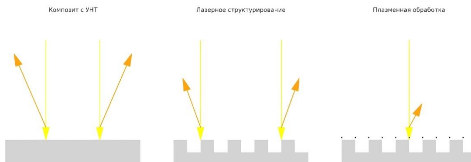
Рис.1. Схема уменьшения отражения при структурировании поверхности.
