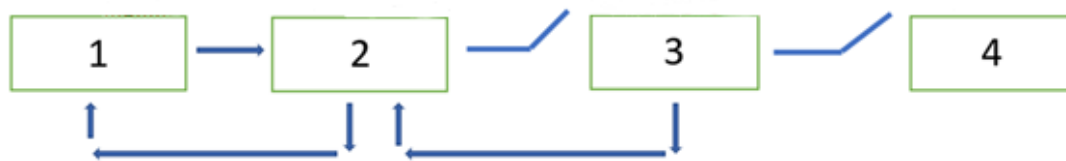
Abb. 1. Das vorgeschlagene Speichersystem ist: 1 - ein Lagerhaus; 2 - ein Temperaturüberwachungsabschnitt; 3- ein Controller; 4 - ein UV-Emitter.
