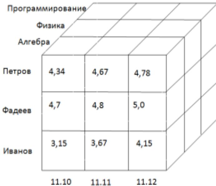
**Рис. 12. Пример трехмерной модели данных**
