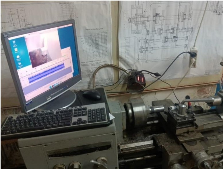
Рис. 1. Экспериментальная установка для записи акустических параметров при токарной обработке
