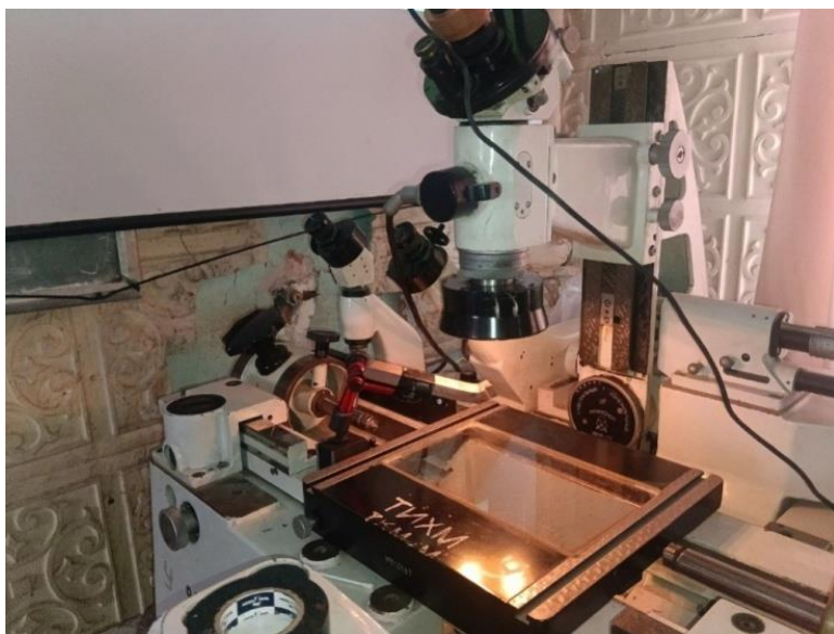
Рис. 2. УИМ-21 для измерения радиуса заточки кромки резца с магнитным штативом
