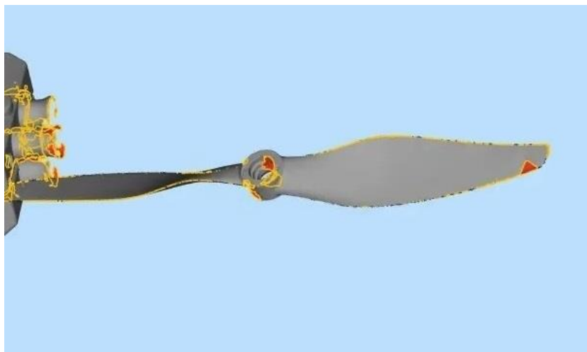
Рис. 2 Облако точек, полученное при 3D-сканировании винта
