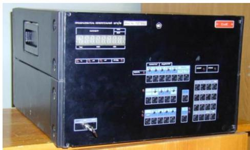
**Рис. 3. Многоканальный измерительный преобразователь Ш711/1-1**
