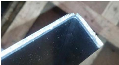
**Рис. 1. Разрыв металла в местах гибки**
