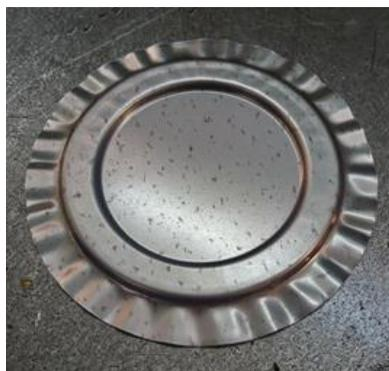
Рис. 4. Деталь с пропущенной операцией калибровки
