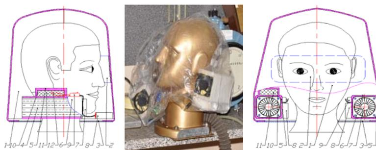
**Рис. 1. Принципиальная конструкция самоспасателя:**
