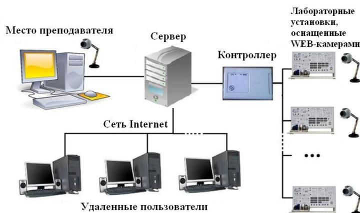
Рис. 1. Структурная схема лабораторного комплекса
