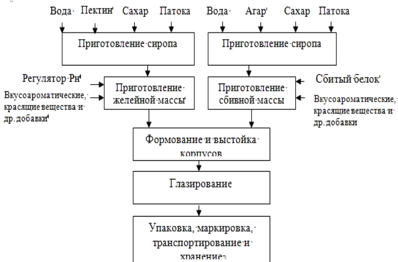
Рис. 1. Структурная схема процесса производства комбинированных желейно-сбивных конфет
