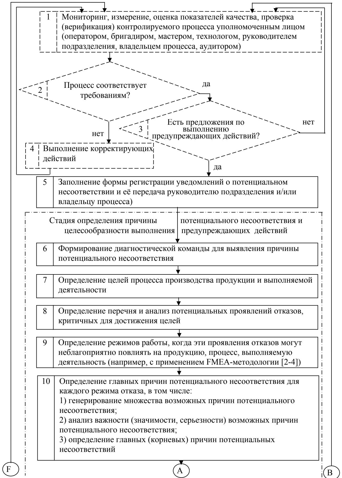
Рис. 3 Поточная диаграмма выполнения процесса предупреждающих действий – для устранения причины потенциального несоответствия (начало)
