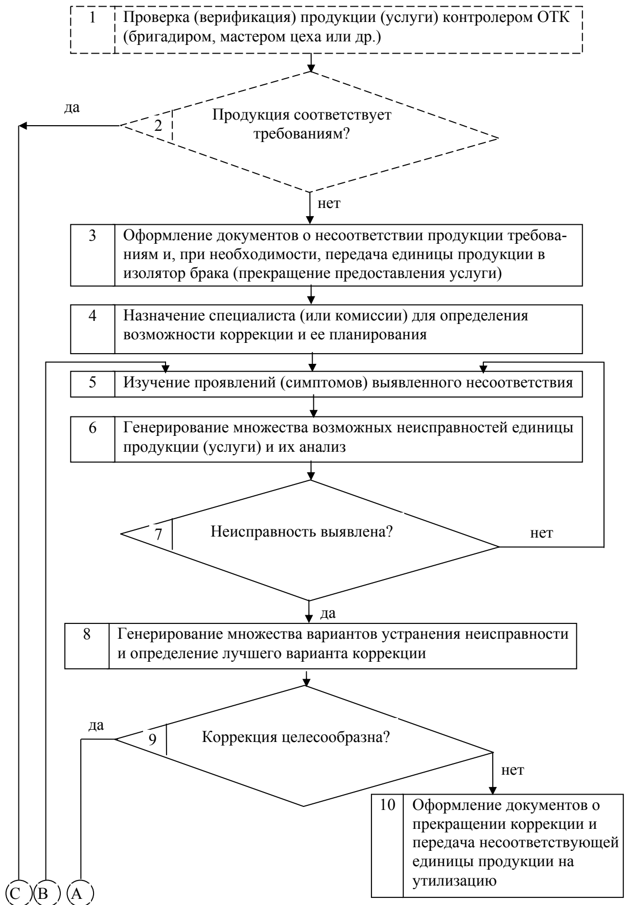
Рис. 1 Поточная диаграмма выполнения процесса коррекции – для устранения выявленного несоответствия конкретной единицы продукции (начало)
