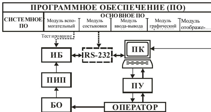
**Рис. 1 Структурная схема автоматизированной системы измерений степени повреждения растительных материалов**
