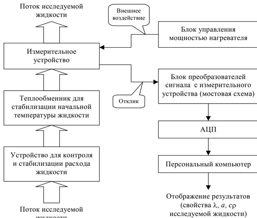
**Рис. 1 Структурная схема измерительной установки**
