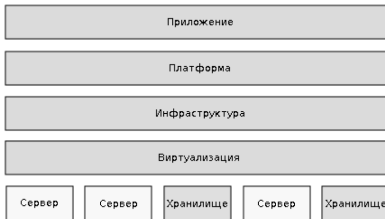
Рис. 1. Уровни, на которых строится Cloud Computing
