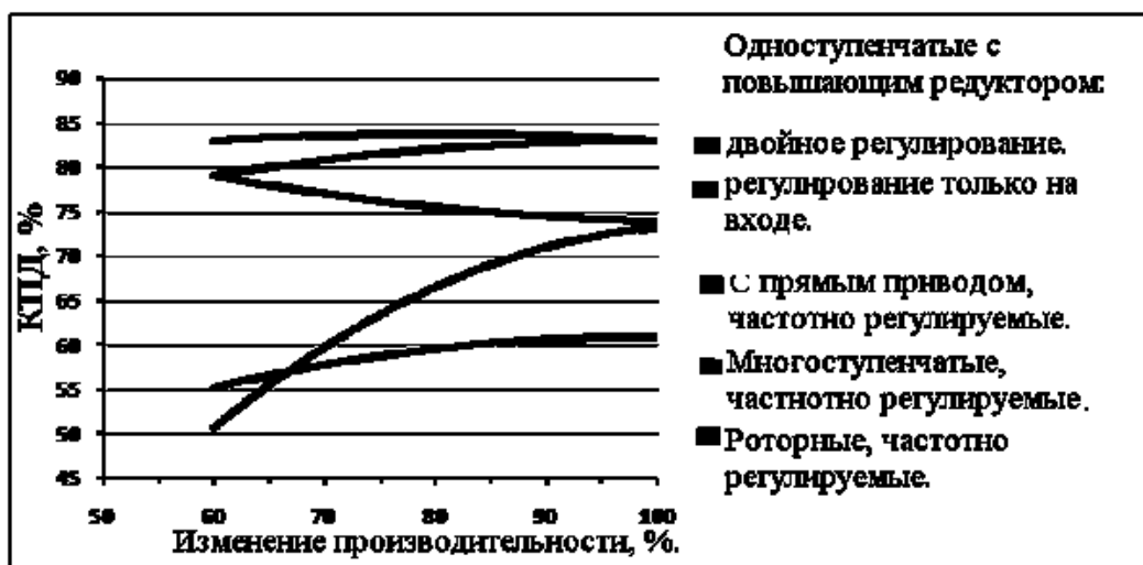
Рис. 1. Зависимости КПД частотно регулируемых приводов от производительности
