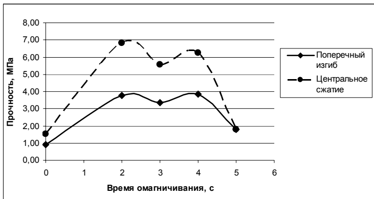
Рис. 2. Мелкозернистый бетон на омагниченной воде
