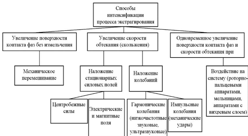
Рис. 2.6. Способы интенсификации процесса экстрагирования
