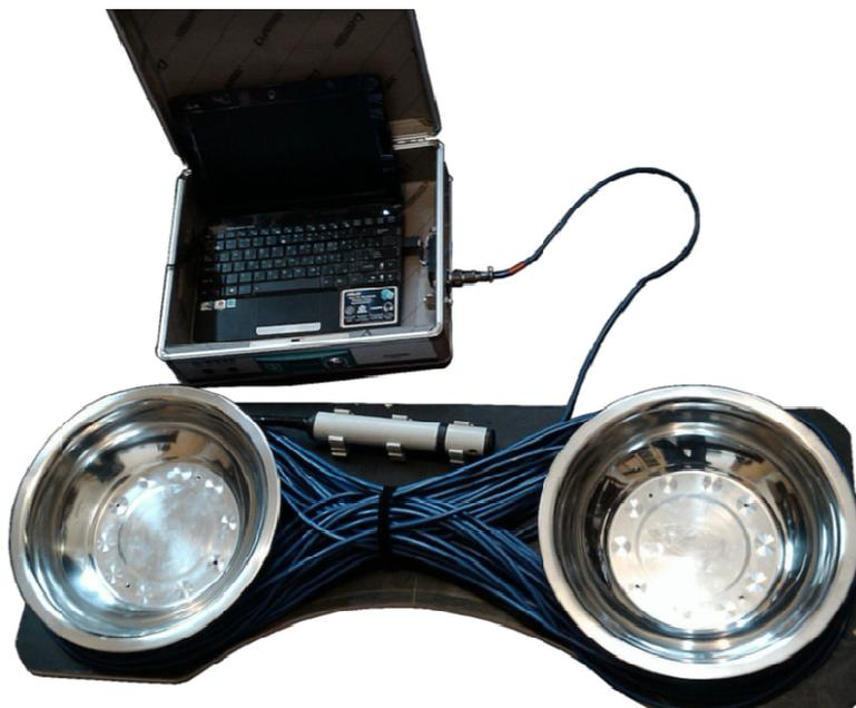
**Рис. 2. Кондуктометр – концентратомер «КАЛЬМАР».**
