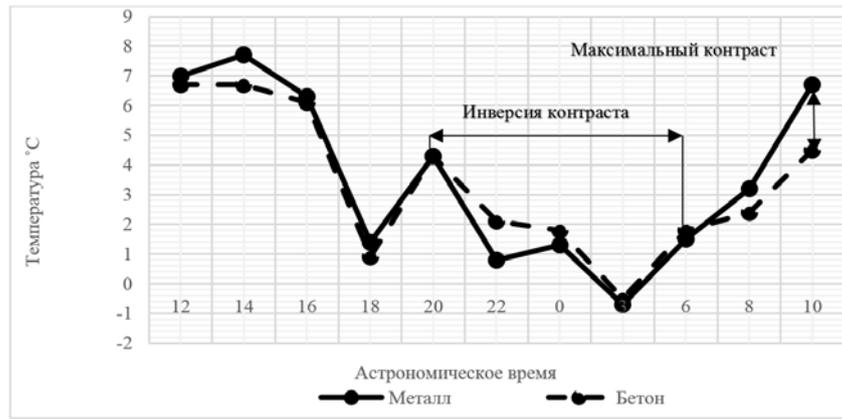
**Рис. 7. Графики изменения радиационных температур для двух разнородных материалов – металлический диск, окрашенный в черный цвет и бетон.**
