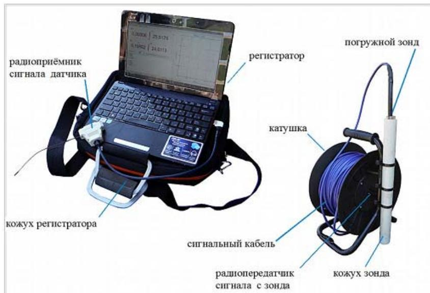
**Рис. 1. Комплектация термометра.**
