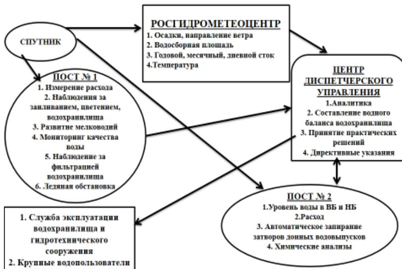
Рис. 2. Модель управления режимом водохозяйственной системы Тамбовского водохранилища на р. Лесной Тамбов
