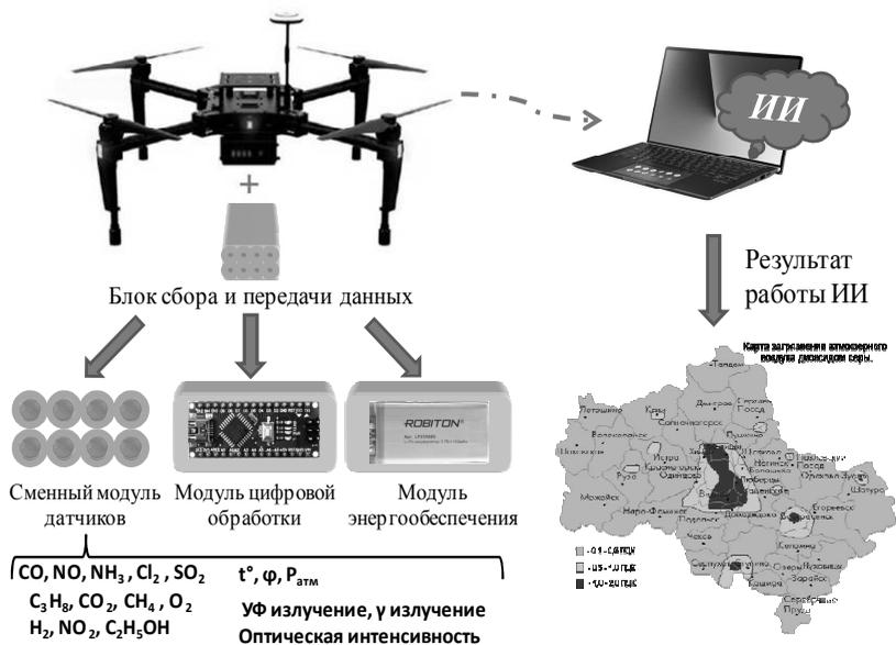
**Рис. 1. Концепция автоматизированной системы экспресс-анализа**
