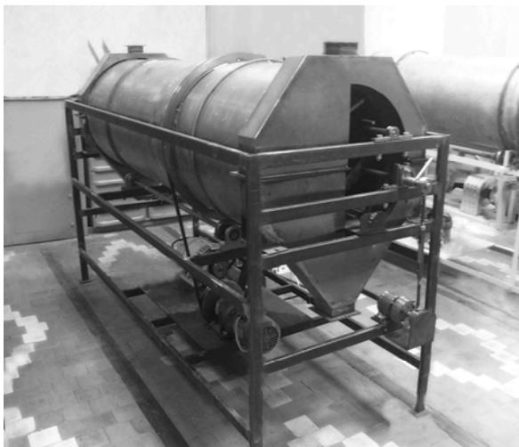
**Рис. 5.5. Опытный образец промышленного аппарата вибросепаратора**
