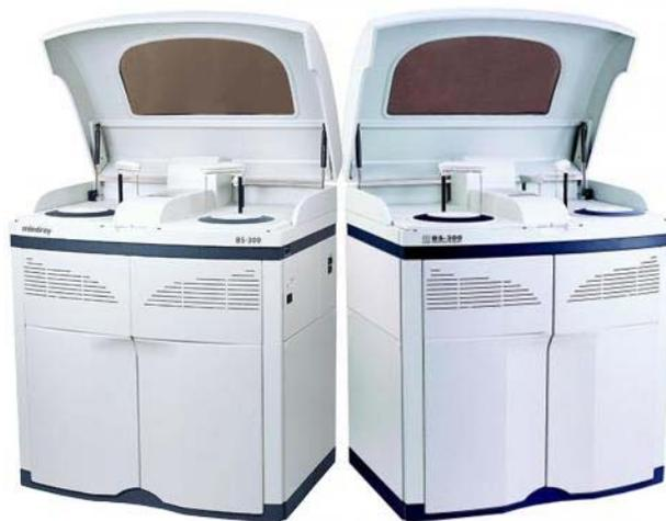
**Рис. 2.6. Биохимические анализаторы BS-300 производства Mindray**
