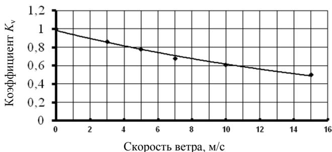
Рис. 3.3. Зависимость коэффициента  $K_v$  от скорости ветра
