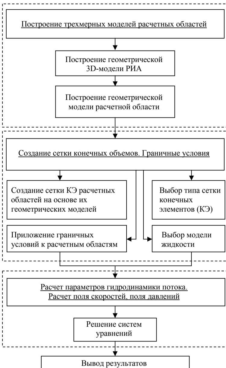
Рис. 3.8. Алгоритм расчета течения потока жидкости в среде ANSYS
