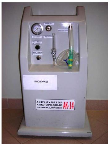
**Рис. 6. Внешний вид мобильного аккумулятора кислорода**
