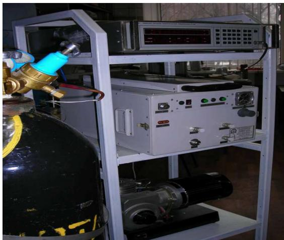
**Рис. 4. Внешний вид установки для двухстадийного разделения воздуха (в центре монтажной стойки – адсорбционный генератор газовой смеси 90%  $\text{O}_2$  + 10%  $\text{Ar}$ )**
