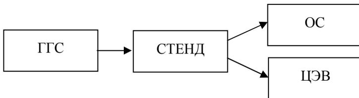
**Рис. 3.3. Структурная схема измерений параметров усилителя мощности:**
