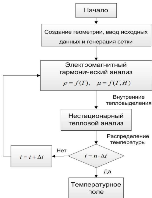
Рис. 6.1. Алгоритм связанного анализа расчёта устройств индукционного нагрева
