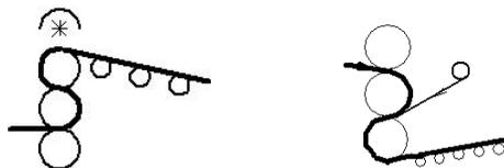
**Рис. 4.17. Способы придания глянца: с помощью ИК-излучения – слева; нанесением плёнки из ПС (ламинирование) – справа**
