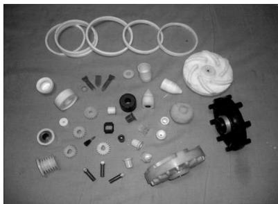
**Рис. 5.22. Изделия для машиностроения, полученные твёрдофазной технологией**
