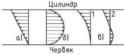
**Рис. 4.3. Эпюры потоков расплава вдоль червяка:**
