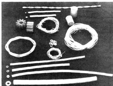
**Рис. 5.7. Изделия из полимеров, получаемые методами твёрдофазной экструзии**
