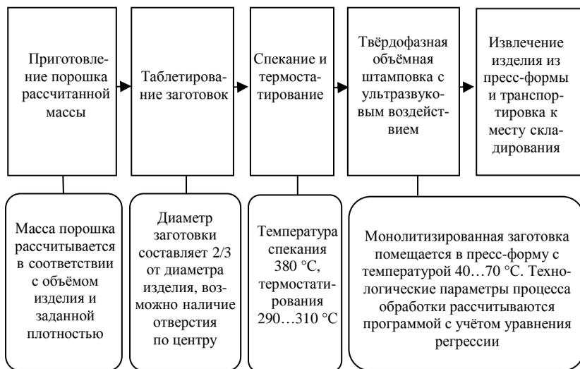
**Рис. 5.24.** Схема технологической линии твёрдофазной объёмной штамповки термопластов с ультразвуковым воздействием [42 – 44]
