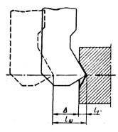
Рис 5. Центрование торца резцом
