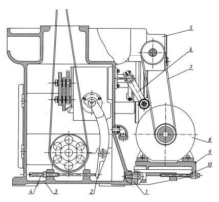
Рис. 16. Основание и привод (разрез)
