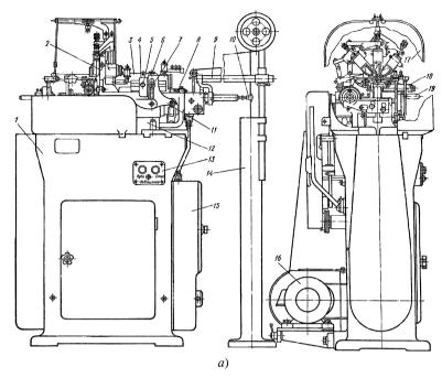
Рис. 4. Автомат продольного точения:
