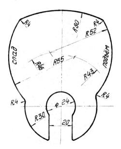
Рис. 14. Шаблон холостых ходов балансира для производительности T свыше 12 шт./мин
