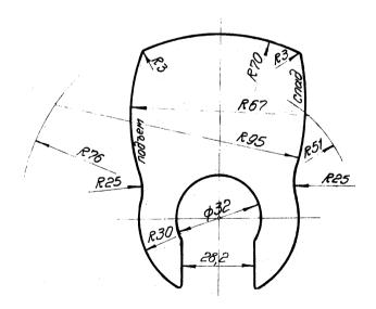
Рис. 16. Шаблон холостых ходов суппортов для производительности T свыше 12 шт./мин
