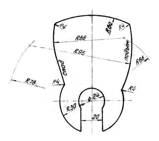
Рис. 12. Шаблон холостых ходов балансира для производительности T до 5 шт./мин
