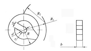
Принцип работы и типовые детали, получаемые обработкой на автоматах продольного точения. Отличительной особенностью автоматов продольного точения (рис. 1) является то, что пруток в них, кроме вращательного движения, имеет вместе со шпиндельной бабкой 6 продольное поступательное перемещение  $S_{\rm прод}$ .
