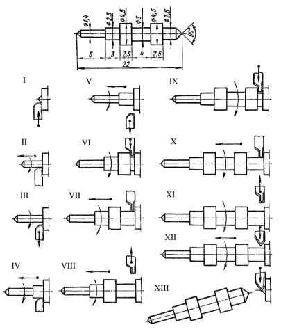
Рис. 2. Схема обработки заготовки на автомате продольного точения
