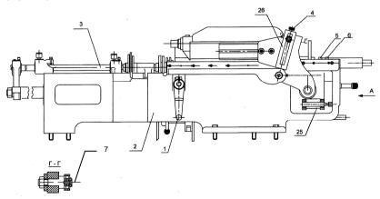
Рис. 6. Станина и распределительный вал
