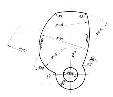
Рис. 9. Шаблон холостых ходов шпиндельной бабки для производительности *T* до 5 шт./мин
