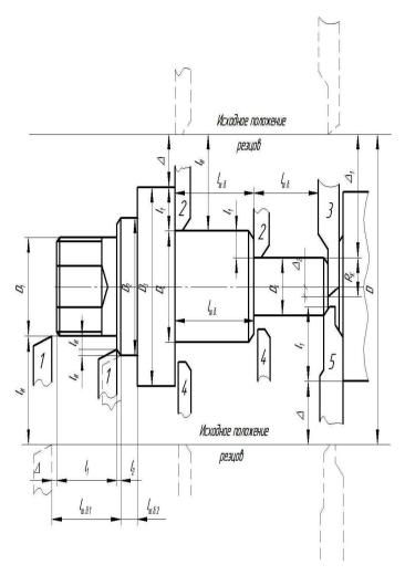
Рис. 2. Рабочий ход инструмента и шпиндельной бабки при обработке детали на автомате продольного точения
