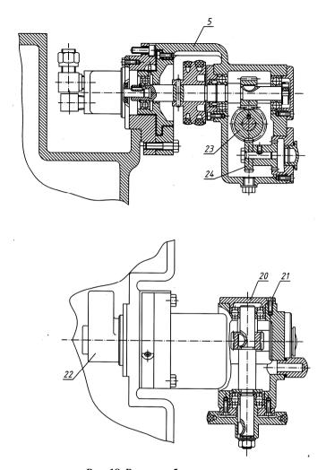
Рис. 18. Редуктор быстрого хода
