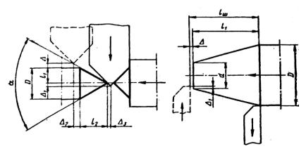
Рис. 3. Обтачивание конуса отрезным резцом
