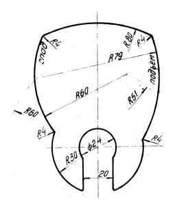
Рис. 13. Шаблон холостых ходов балансира для производительности T от 5 до 12 шт./мин
