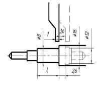
Рис. 8. Определение длины рабочего хода шпиндельной бабки для врезания лопаточным резцом
