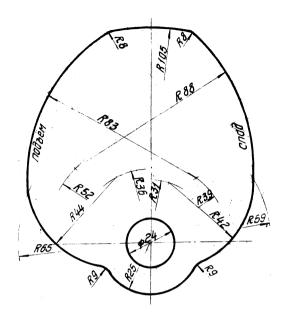
Рис. 11. Шаблон холостых ходов шпиндельной бабки для производительности T свыше 12 шт./мин
