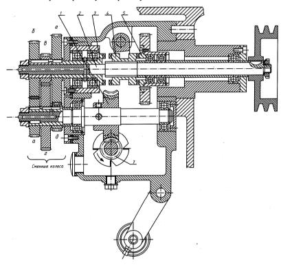
Рис. 14. Коробка подач (разрез)
