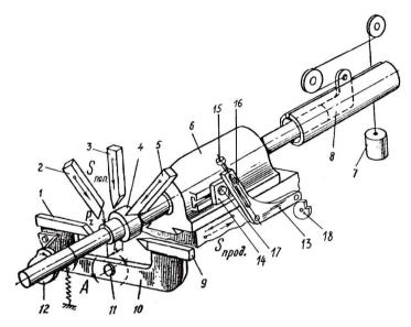
Рис. 1. Схема работы автоматов продольного точения
