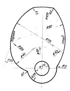
Рис. 10. Шаблон холостых ходов шпиндельной бабки для производительности T от 5 до 12 шт./мин
