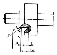
Рис. 6. Обтачивание поднутрений резцом
