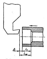
Рис. 7. Растачивание отверстий резцом перехода 17
