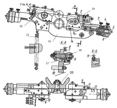
Рис. 13. Балансир с суппортами токарного автомата продольного точения
