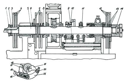
Рис. 21. Распределительный вал с дисковыми кулачками и ригельными барабанами
