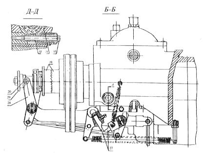
Рис. 10. Вид системы блокировки
