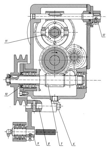
Рис. 15. Коробка подач (разрез по червячной передаче)
