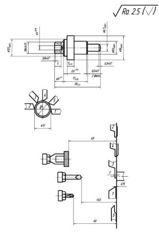
Рис. П.1. Чертёж детали «Палец» и схема расположения инструментов
