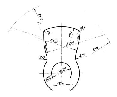
Рис. 15. Шаблон холостых ходов суппортов для производительности T до 12 шт./мин
