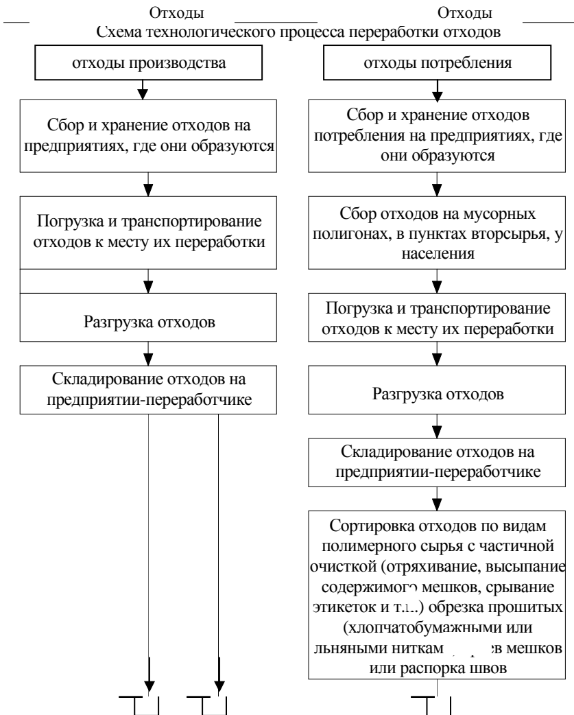
Рис. 4. Схема технологического процесса переработки отходов
