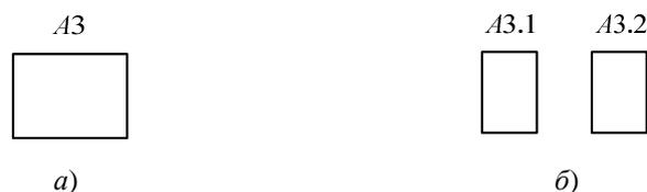
Рис. 1. Указание позиционных обозначений для совмещённого (а) и разнесённого (б) способов изображения устройства
