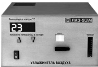
Рис. 8. Увлажнительная камера
