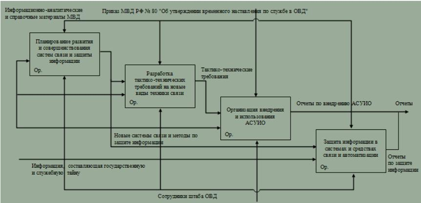
Рисунок 1 - Функциональная модель организации всех видов связи и средств автоматизации
