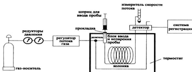
Рис. 5.17. Схема устройства газового хроматографа
