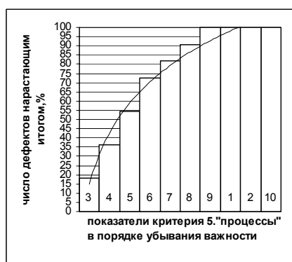
Рис. 3.5. Диаграмма Парето кайзен резервов в процессах С КБ 3.5. Анализ показателей критерия «Руководство» С КБ
