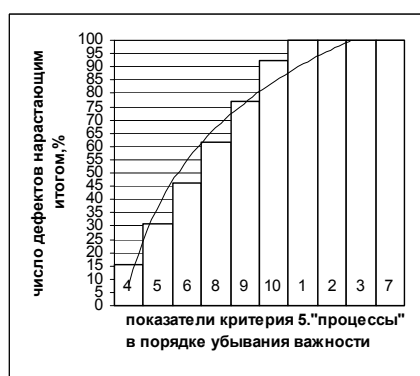
Рис. 3.14. Диаграмма Парето кайзен резервов в процессах Р КБ 3.14. Анализ показателей критерия «Руководство» Р КБ
