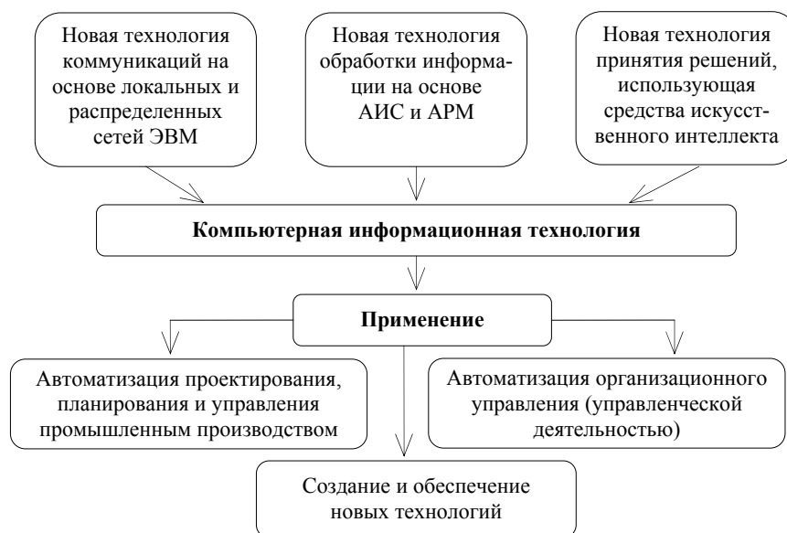
Рис. 5. Составные части компьютерных НИТ и области их применения
