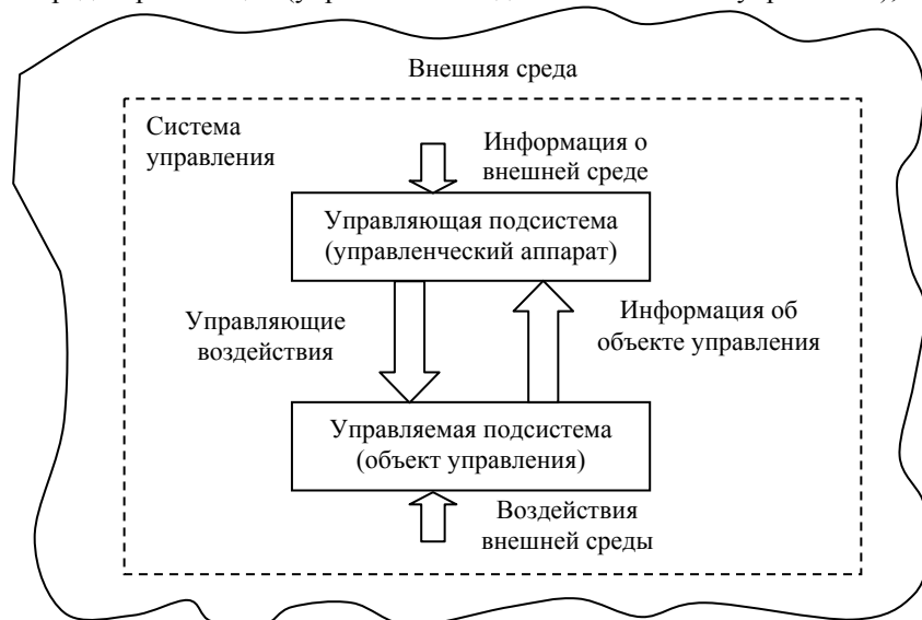
Рис. 1. Структура системы управления (кибернетический подход)
