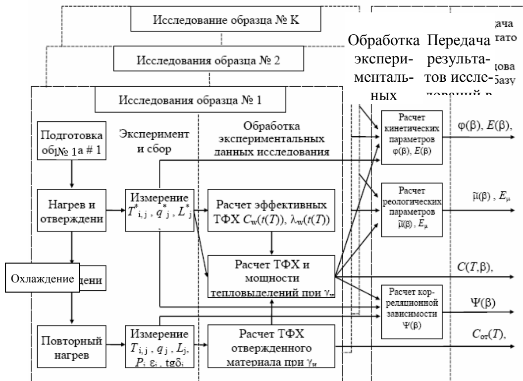
Рис. 6.17. Структура обработки экспериментальных данных в ИИС
