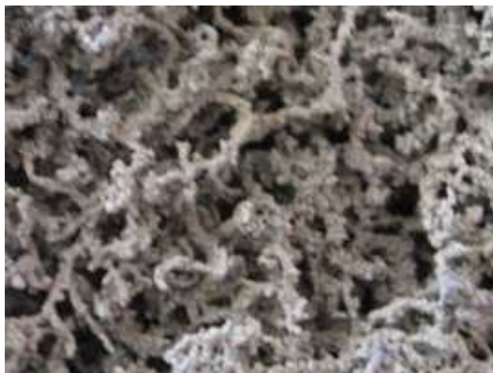
Рис. 3.1. Структура NiO/MgO катализатора 3.2. Состав NiO/MgO катализаторов
