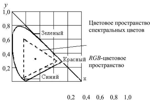
Рис. 4.6. Диаграмма цветности xy с нанесённым на неё цветовым охватом гипотетического RGB -устройства
