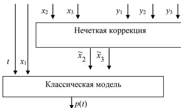
Рис. 1. Гибридная модель участка автоклавов
