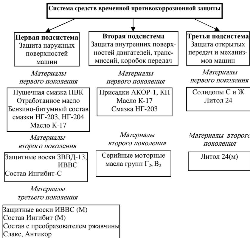
**Рис. 6.1. Средства временной противокоррозионной защиты сельскохозяйственной техники**
