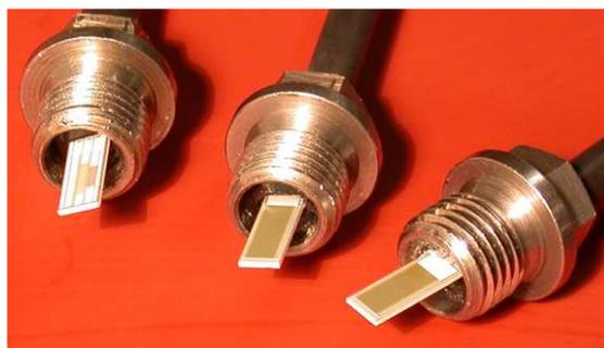
Рис. 8.18. Датчик для измерения состояния смазочных материалов
