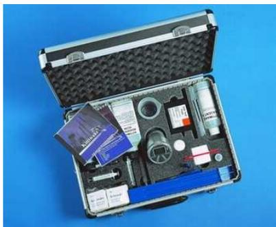
Рис. 8.9. Портативная лаборатория «Kittiwake» для анализа качества смазочных материалов и топлив
