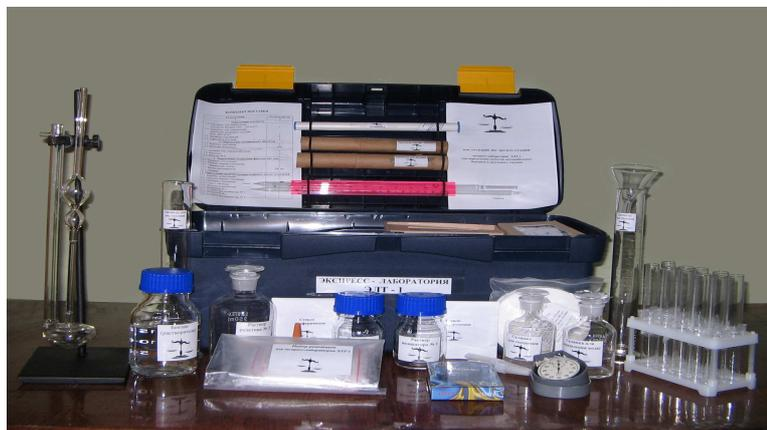
**Рис. 8.2. Экспресс-лаборатория типа ЭЛТ-1**
