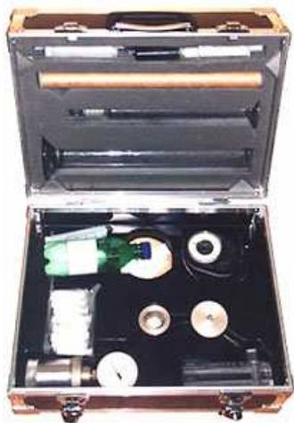
Рис. 8.7. Портативная лаборатория анализа масел и топлив ПЛАМ
