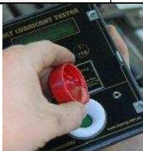
Рис. 8.14. Тестер контроля качества моторного масла «ALT»
