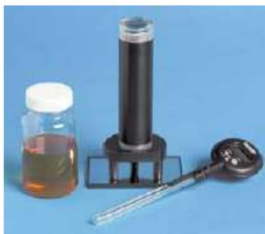
**Рис. 8.12. Тестер для анализа вязкости моторных, трансмиссионных масел, дизельного топлива**
