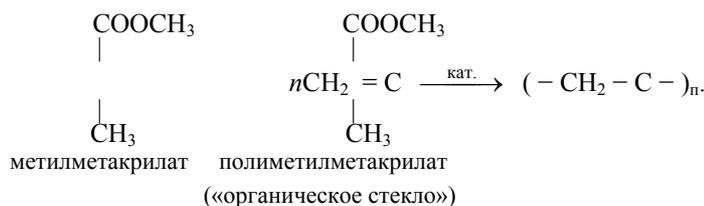
Разрыв кратной связи или цикла может произойти под действием катализаторов, свободных радикалов, нагревания, высокого давления, света.
