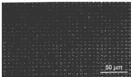
**Рис. 3.4. Микрофотография, демонстрирующая гомогенное распределение УНТ в сетке квадратиков на подложке Si/SiO<sub>2</sub> (катализатор – раствор нитрата железа при 720 °С)**
