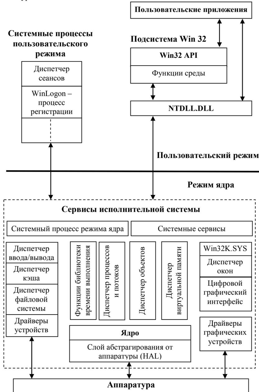
**Рис. 1. Архитектура Windows NT в упрощенном виде**
